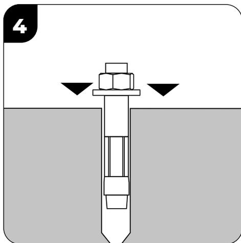
4 - Coloque o chumbador montado e ajuste no ponto de expansão;
