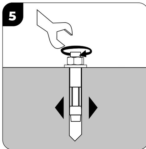
5 - Para inserir o prisioneiro, aperte-o com torque suficiente para expansão da jaqueta;
